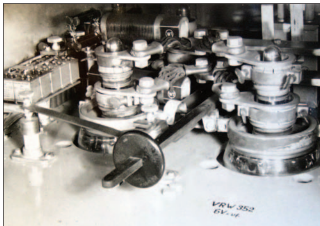
15. ábra. 3 db párhuzamosan kapcsolt nagymerekségű modulátor cső kellett a 30 kW-os végfokozat videó rácsmodulációjához
