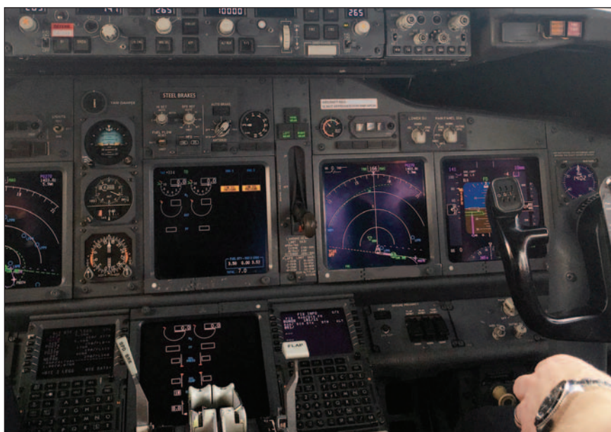
2. ábra. Az első tiszt („másodpilóta”) előtti szerelvényfal, a „glass cockpit” a képernyőkkel
