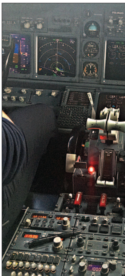
1. ábra. A pilótafülke középső része, az 1 és 2 jelű karok a hajtóművek tolóerő-szabályozói
