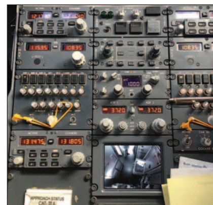
3. ábra. A fülke közepén lévő konzol a kommunikációs berendezések kezelőpaneljeivel
