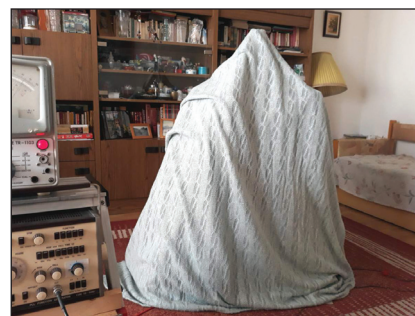
Mérés hangszigetelt környezetben. A hangfal és a mikrofon a hangszigetelő sátor alatt
