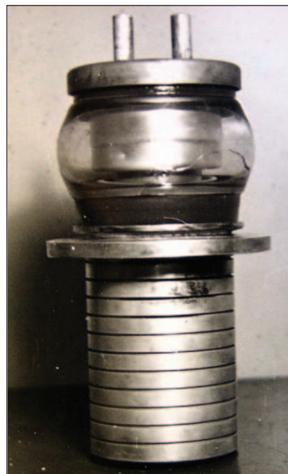
12. ábra. A képadó egyik meghajtó-fokozati vízhűtéses adócsöve. A nagyméretű alsó, ezüstözött vörösréz henger a cső anódja
